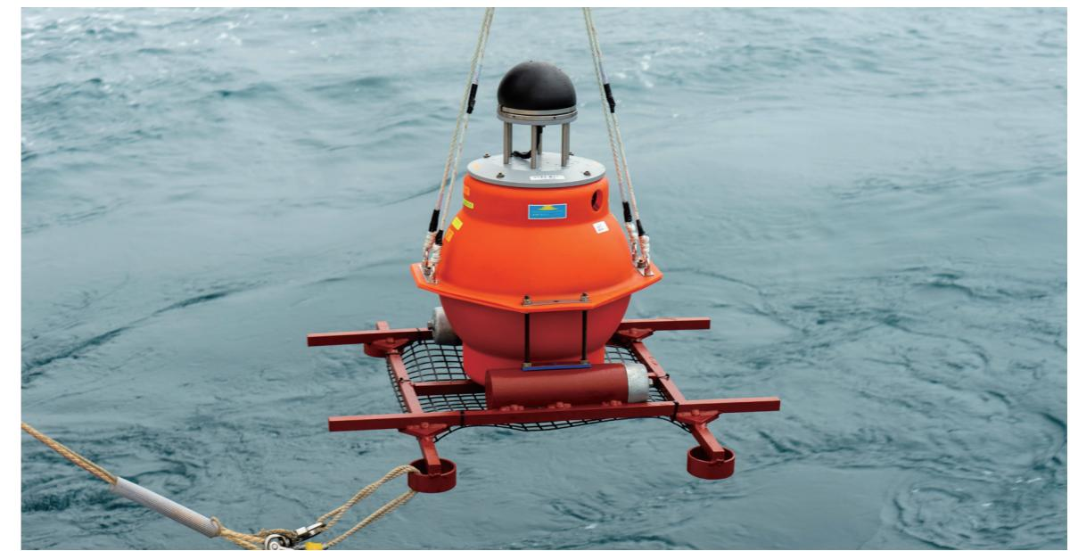
図1. GNSS-A 観測用の海底局設置時の様子。海上の船舶等との距離は音響測距で行います。
