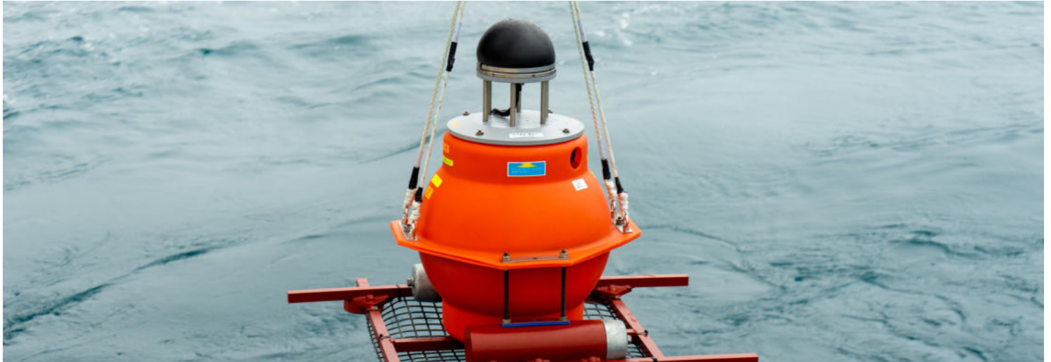
図 1. GNSS-A 観測用の海底局設置時の様子。海上の船舶等との距離は音響測距で行う
